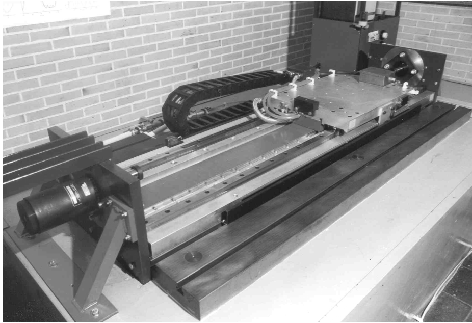
Abb. 1: Versuchsstand des Lineardirektantriebs
