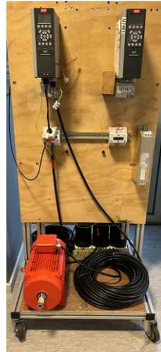
Entwicklung eines Prüfaufbaus, der als Referenzsystem dient, um Maßnahmen zur Reduzierung von PE-/PA-Strömen reproduzierbar beurteilen zu können. Hierzu sollte sich das Referenzsystem möglichst nah an realen Systemen orientieren.
