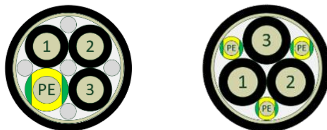
Abbildung 43: Motor-/Servoleitungen gemäß der VDE-Bezeichnung 2YSLCY oder 2XSLCY. Klassischer Aufbau (links) und erdsymmetrischer Aufbau mit drei Schutzleiter (rechts).
