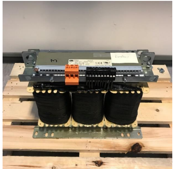
Abbildung 37: 8 kVA, TT3 8-4-4 Transformator von BLOCK
