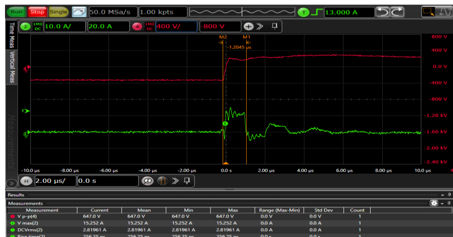
Abbildung 104: Oszi-Bild der Messung zur Überprüfung der Leitungstheorie
