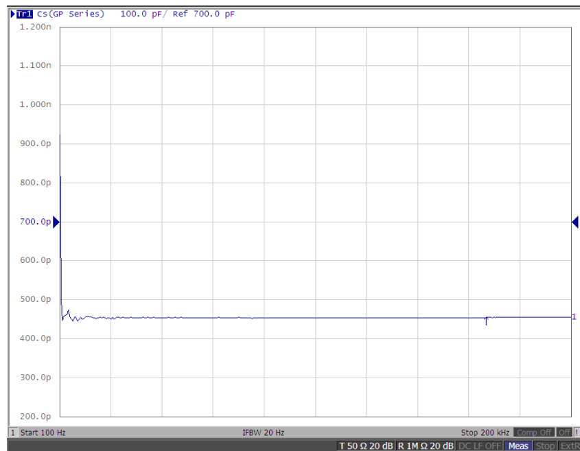
Abbildung 34: Kopplung zwischen der Primär- und Sekundärseite des Trenn-Trafo. 100 Hz...200 kHz => ~460 pF (etwas höher bei niedrigeren Frequenzen)
